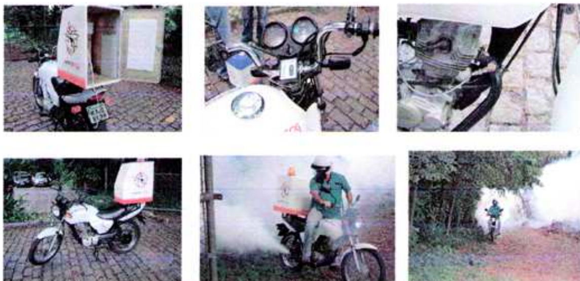
Fotos mostrando os diversos componentes do Kit montado em uma motocicleta
